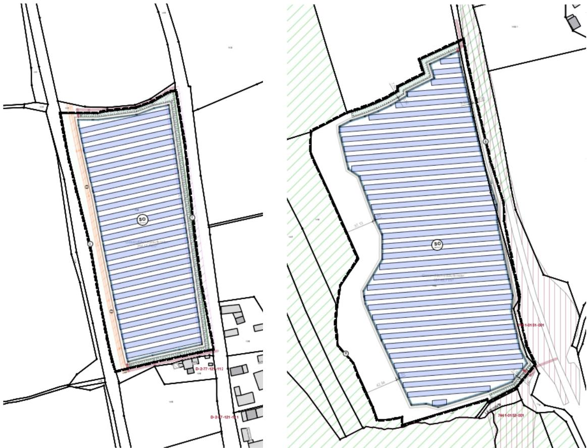
Voraussichtliche Flächenbelegung mit PV-Modulen GB 1 und 2 M 1 : 5.000
