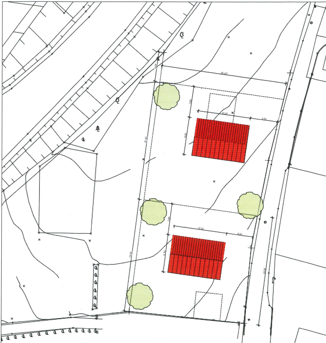
Abbildung 1: Lageplan mit Kennzeichnung der geplanten Gebäude /8/
